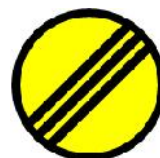
Fin de Zona de Control
